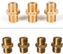
Ensemble de raccords en laiton pour l'installation sur le régulateur de pression de carburant du générateur lorsqu'il fonctionne au-dessus de 2000 pieds (610 m). Applicable à tous les modèles à double carburant (DF).
